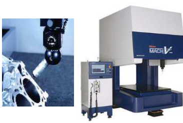
ミツumi MACH9106 インライン対応CNC3次元自動測定ロボットシステム(国際ロボット展2017展示機)
