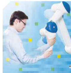
安川電機 HC10 6軸人協働ロボット
