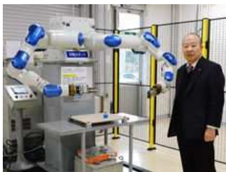
安川電機 DIA10 15軸双腕(組立)ロボット
